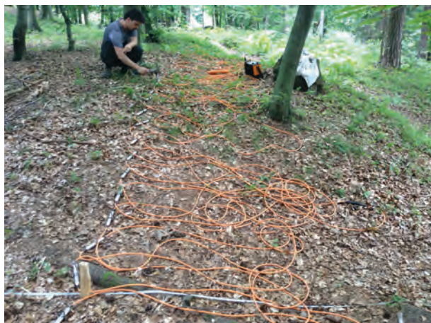
Slika 18. Primer izvajanja upornostnih meritev za 2D geoelektrično tomografijo z instrumentom ARES. postavljenimi elektrodami z medsebojno oddaljenostjo 0,3 m na eni od manjših gomil na Pošteli.
