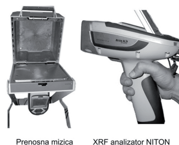
Slika 2. Prenosni XRF analizator NITON GOLDD XL3t+ (foto: M. Udovič, NTF).
